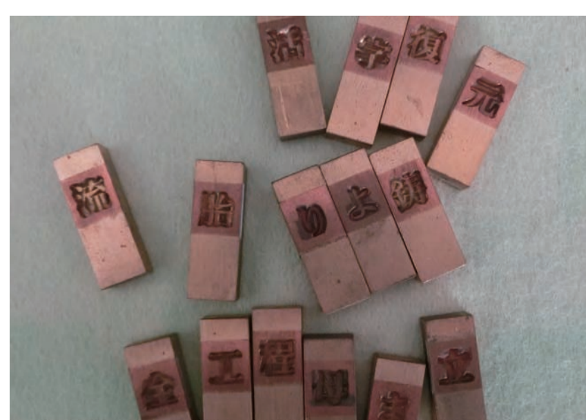
5: 電胎版を真鍮に嵌め込み凹型の母型となる
